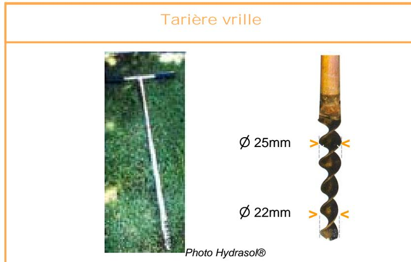
La tarière vrille est un outil adapté à la mise en place des sondes tensiométriques Watermark. Elle permet de réaliser des trous dans le sol à la profondeur souhaitée sans endommager les racines et en permettant un contact parfait entre la sonde et le sol.
